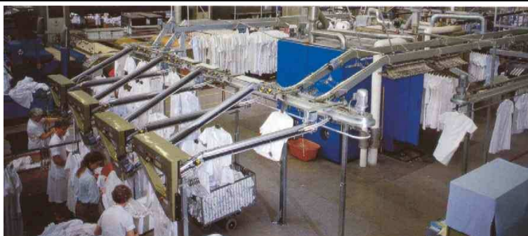
Transport van schoongoed via hangbanen
