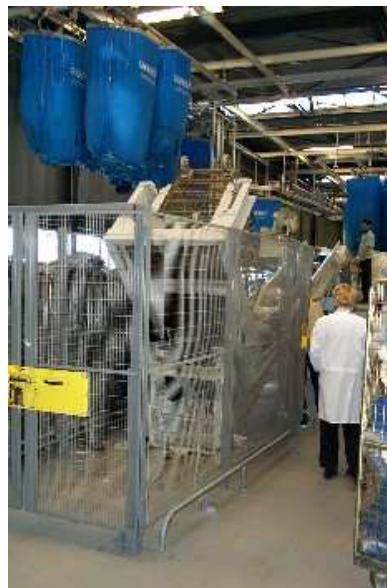
Waszaktransport via hangbaan aan plafond
